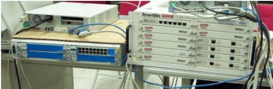
圖二： 測試儀器 Spirent Smartbits 6000B、Agilent Router Tester 900、IXIA ANVL (安裝於 PC 內)
